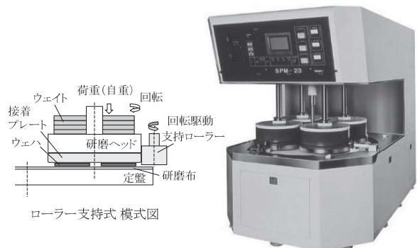
図5 バッチ式片面研磨装置 1) (ローラー支持式)
