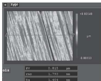
図1 ロータリ研削加工後のSiウェハの表面粗さの一例
