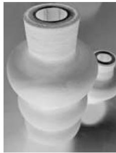
コールドスプレー法で作製した空洞
